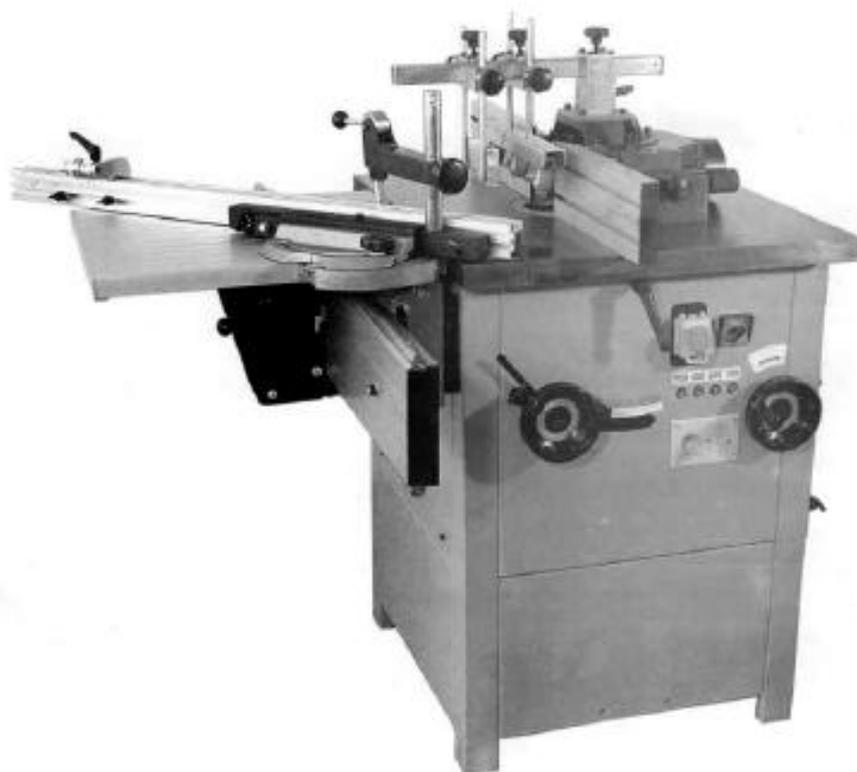
**Фрезерный станок по дереву
